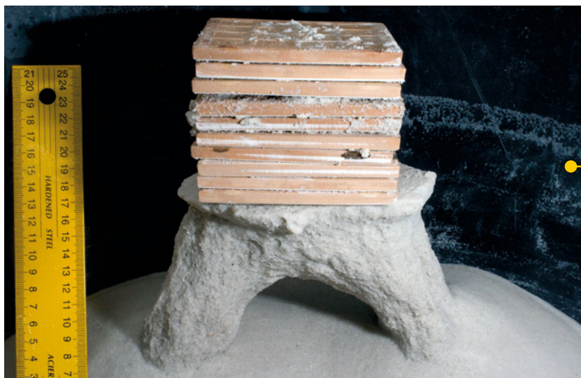
Výsledek pokusu se „zamčeným pískem“ ze Střelče - perfektní experimentální brána, vytvořená opakovaným zaplavením zatíženého bloku s obdélníkovým otvorem. Foto: Jiří Bruthans a kolektiv.
